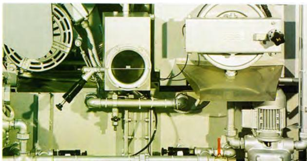
Современная система охлаждения растворителя с контролем температуры в корзине позволяет качественно чистить изделия из деликатных тканей, кожи, замши и меха.
