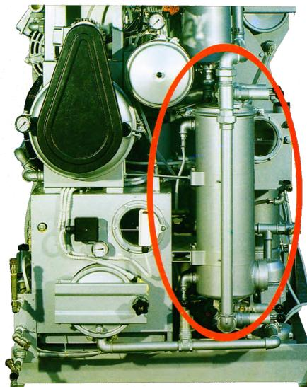
Самоочищающиеся беспорошковые нейлоновые фильтры большой емкости выполнены из нержавеющей стали, экологически безопасны и обеспечивают дополнительную защиту окружающей среды.
