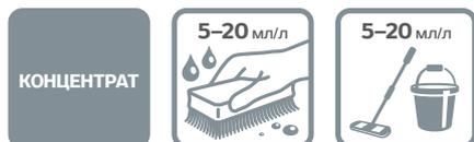
Средство предназначено для ручной и машинной уборки. Используется в виде водного раствора в концентрации 5–20 мл на 1 л воды в зависимости от способа применения и степени загрязнения. Температура воды +40...+80°C. Рабочий раствор средства нанести на поверхность, оставить на 15–50 минут. Обработать уборочным материалом, тщательно смыть водой.
